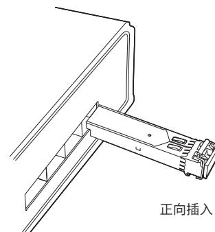
2、将光模块沿SFP槽导轨向内轻轻推入，直到与主机槽底紧紧相接，安装到位时，会听到清脆的金属弹片声，注意保持锁扣处于紧扣的状态。
