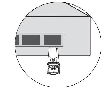
光模块分别插入交换机的SFP插槽
