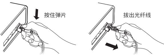
2、将光模块锁扣扳下，手拉住拉环，将光模块平行拔出。
